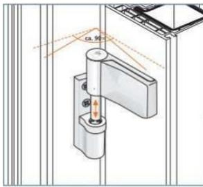
Gondage et dégondage de la porte avec un angle d'ouverture de 90°. Expulser l'axe si nécessaire.
